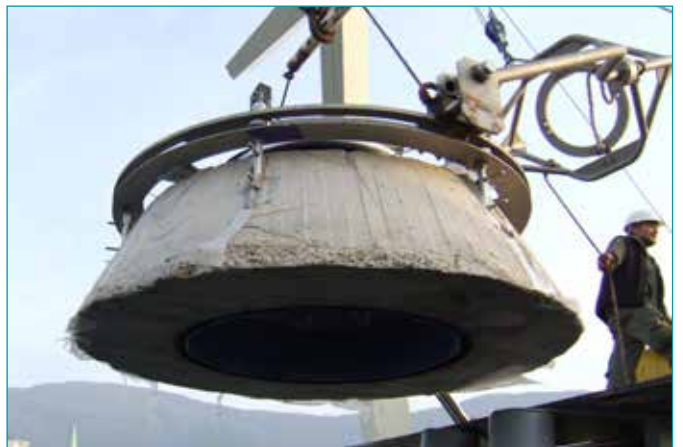
可选的穹顶形混凝土防护罩可以有效减小噪声影响并保护仪器设备不被渔网拖动
